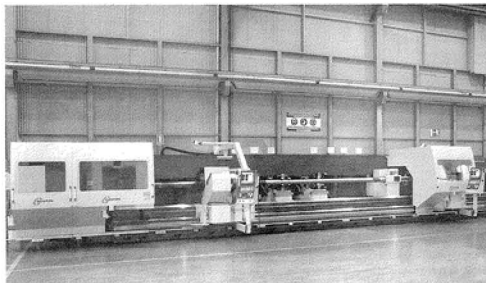
Gurutzpe fabrica tornos de grandes dimensiones que facilitan el torneado de piezas de mayor peso y diámetro
