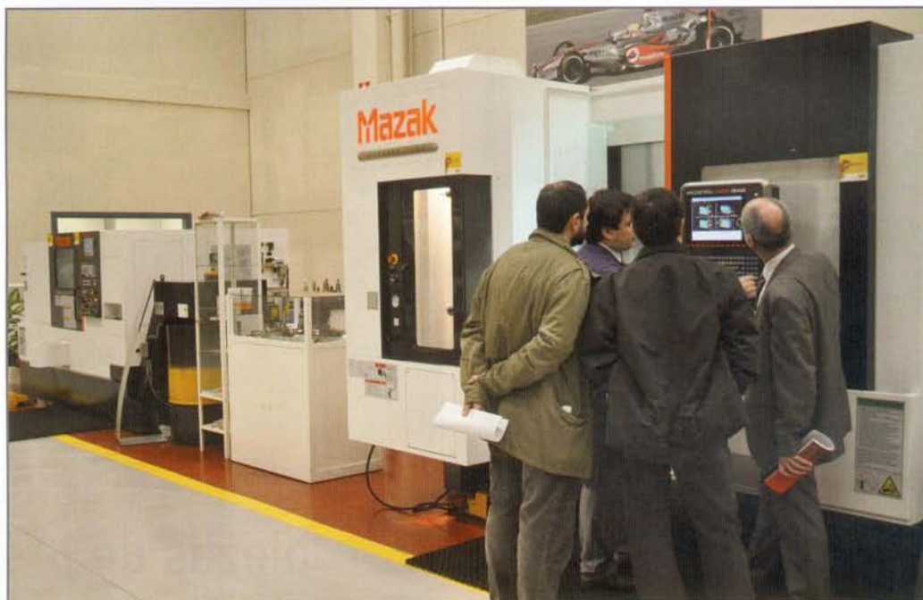
▲ Al fondo a la izquierda, el Quick Turn Smart 200M/500 de Mazak, el centro de torneado de elevadas prestaciones e inversión ajustada que completa la exitosa gama Quick Turn. En primer plano, varios asistentes a las jornadas interesándose por el centro de torneado y fresado INTEGREX J-200, equipado con el control Mazatrol Matrix Nexus
