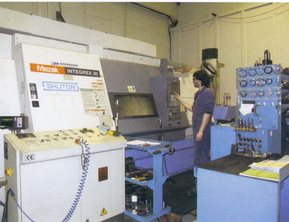
Para el mecanizado de extremos y de las tuercas han confiado desde el principio en el Integrex de Mazak
