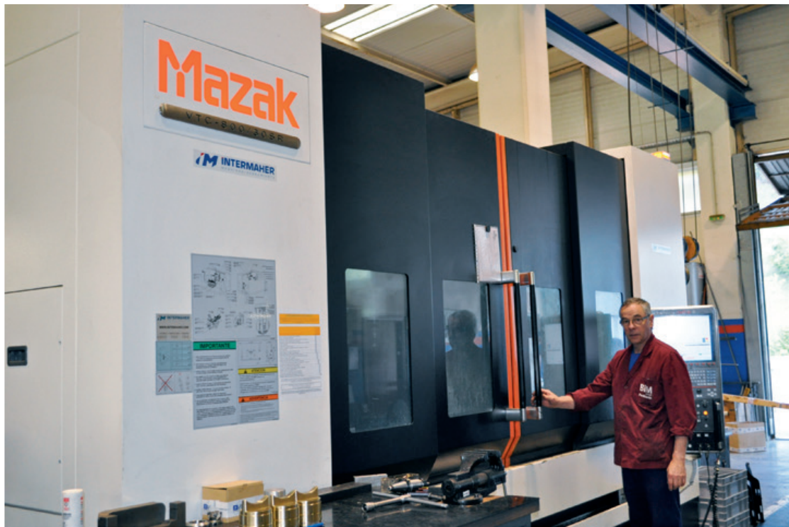
El centro de mecanizado vertical VTC 800/30 SR de Mazak, con cabezal basculante combinado con su mesa rotativa, fue la puerta de entrada de Perihortz al mecanizado completo en 5 ejes simultáneos
