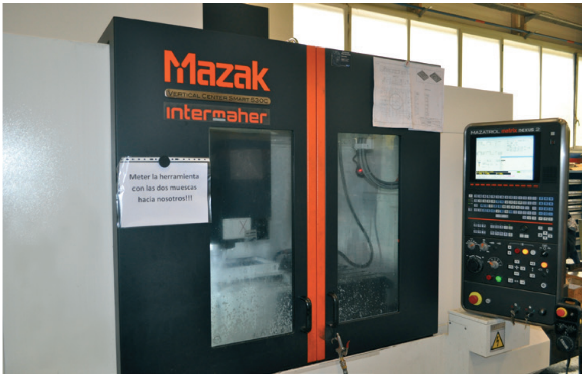
El centro de mecanizado vertical Mazak VCS 530C con CNC MAZATROL MATRIX Nexus 2 fue instalado por Intermaher en Perihortz hace tan solo unos meses
