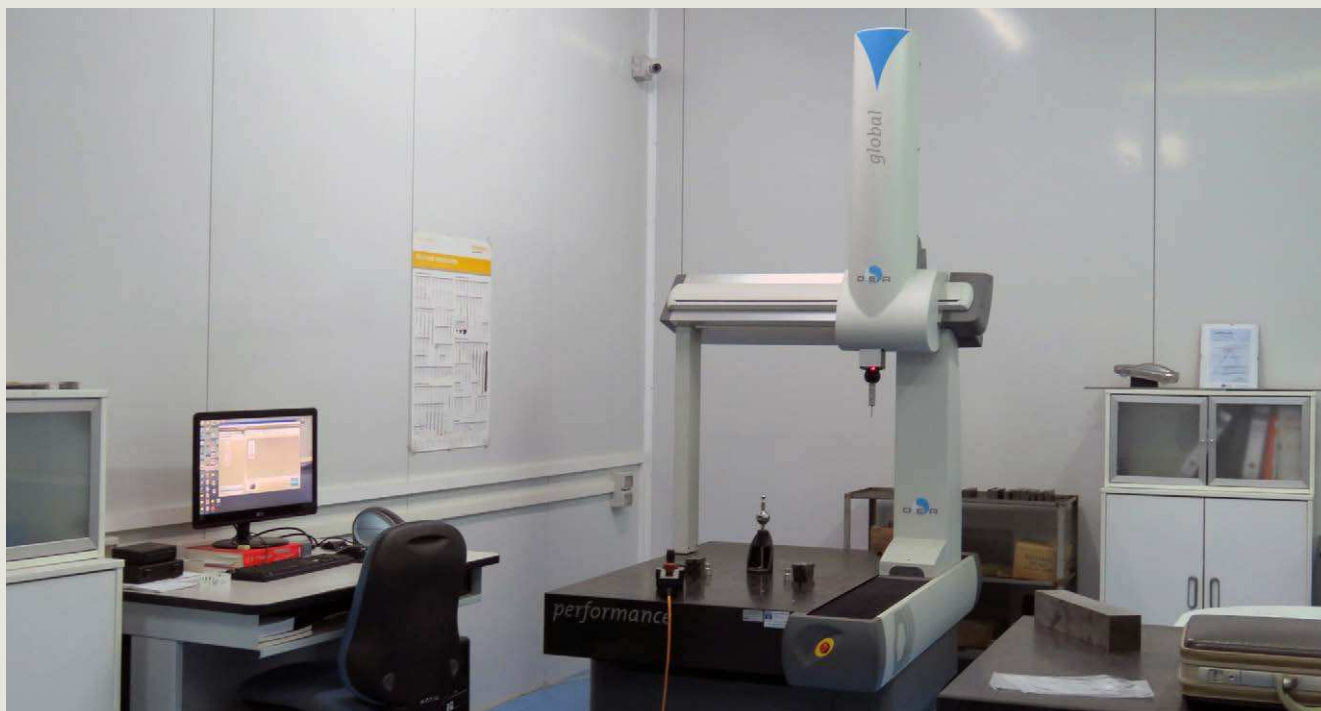
La sala de calidad donde el sistema de medición tridimensional valida, por segunda vez, cada una de las piezas.
