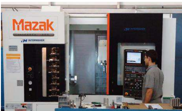
En la imagen, el centro de torneado y fresado Mazak Integrex J200.
