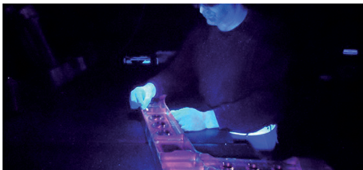
■ Un operario de INMAPA Aeronáutica realizando un test no destructivo de ensayo de grietas por líquidos penetrantes
