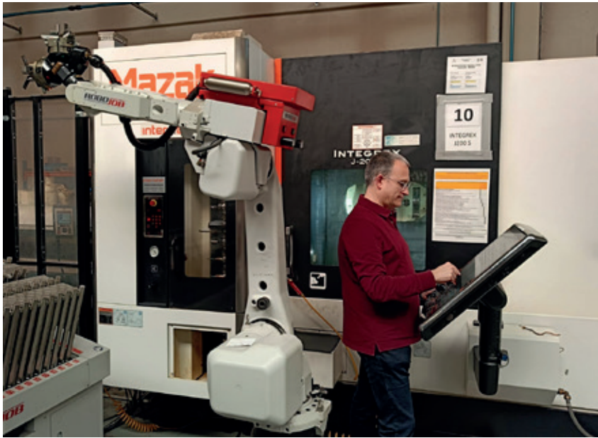
El Integrex equipado con un Robojob y un cargador de barras automático
