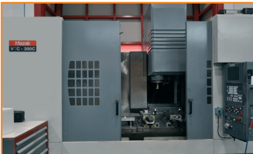
El centro de mecanizado VTC 300C está instalado ahora en la sección de ingeniería por sus particulares prestaciones para el mecanizado de materiales como el aluminio
